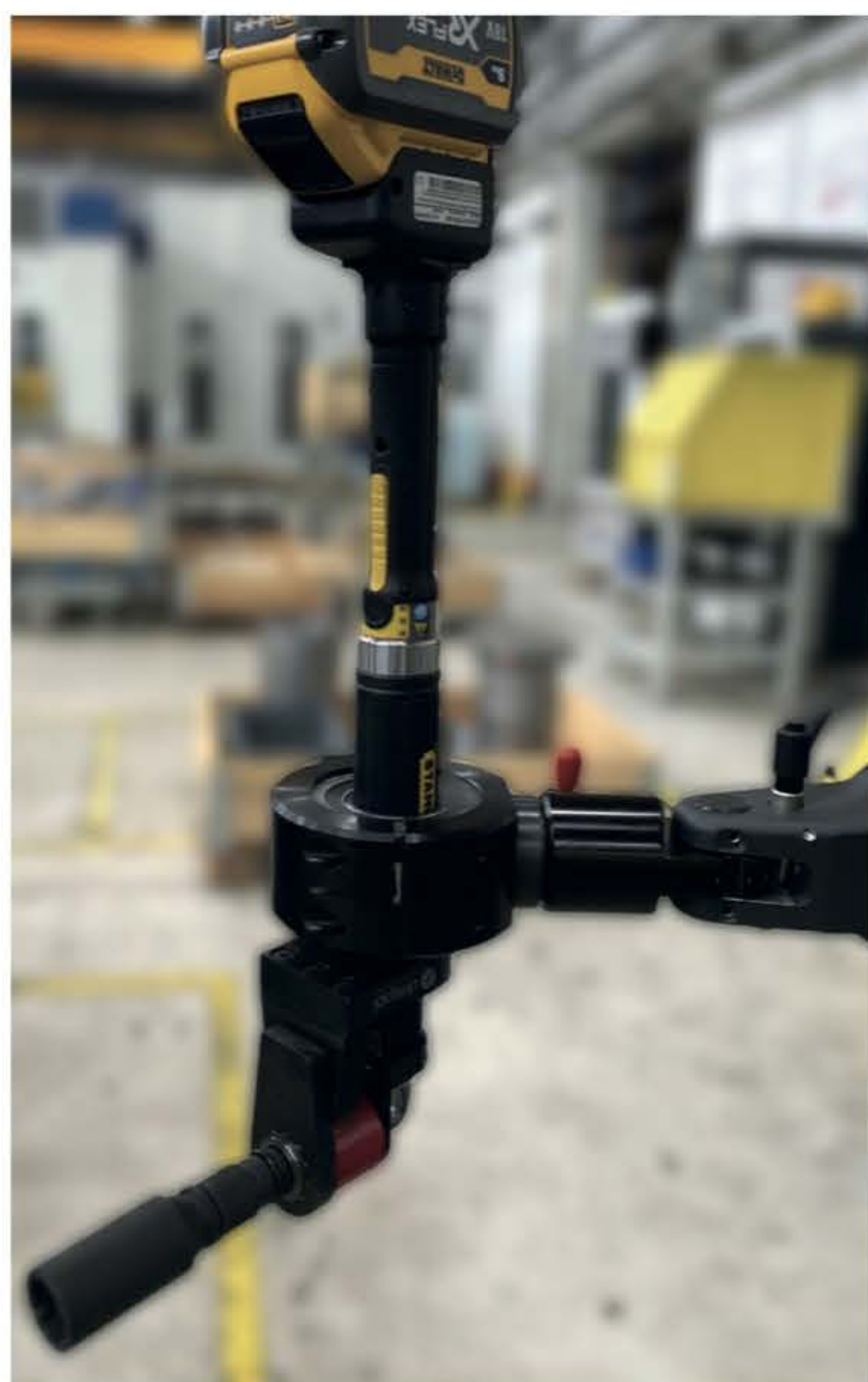
Stanowisko montażowe wyposażone we wkrętkę ASG z podajnikiem wkrętów zamontowaną na ramieniu reakcyjnym
