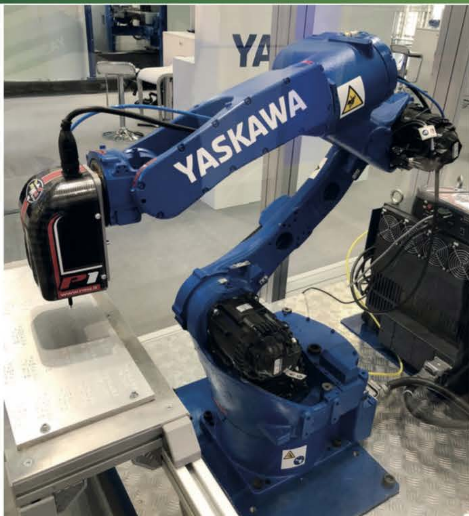
Znakowanie korpusów w różnych płaszczyznach przy pomocy znakowarki mikropunktowej na ramieniu robota Yaskawa
