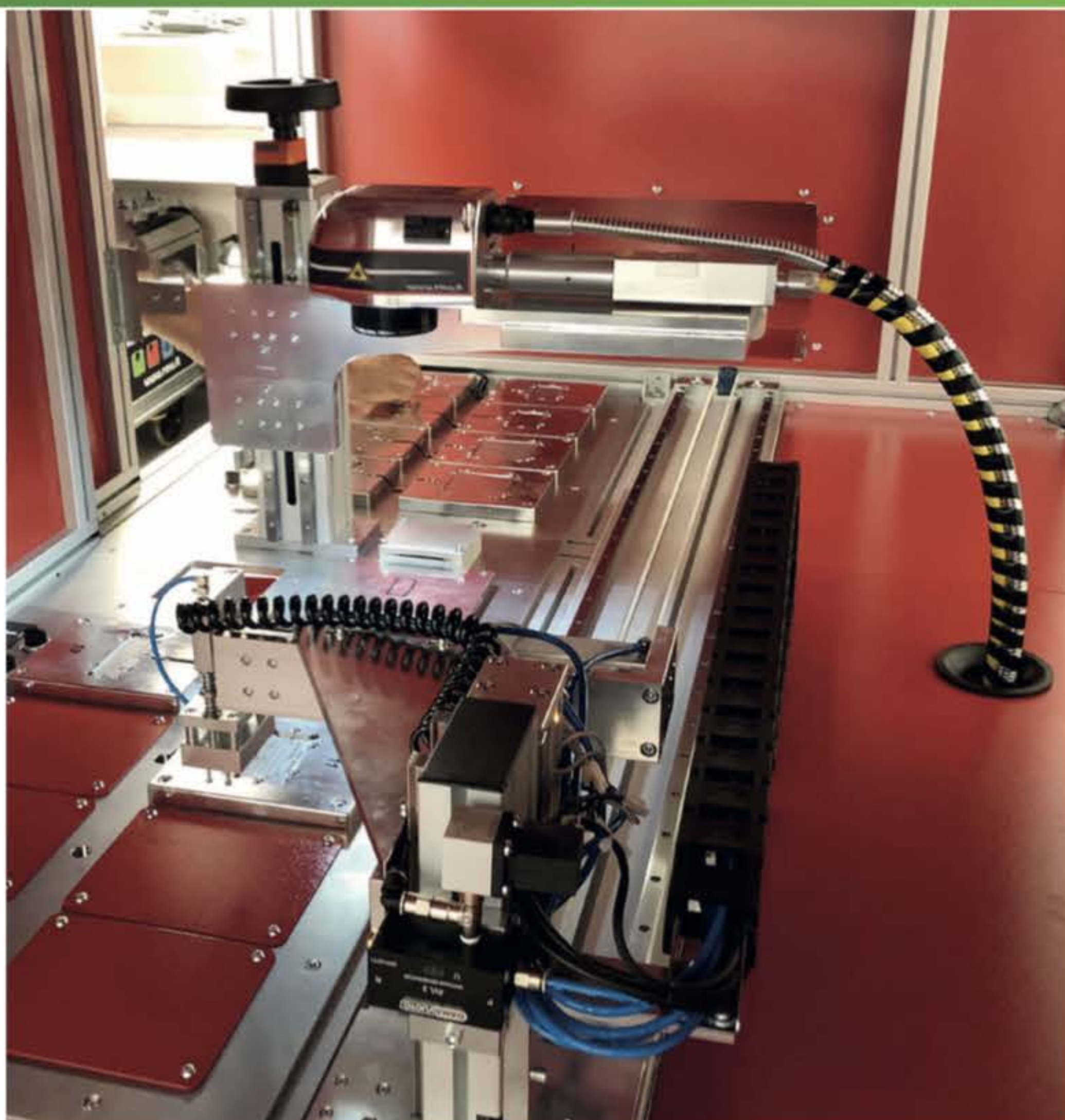
Automatyczna znakowarka laserowa RMU do tabliczek znamionowych. Znakowanie ośmiu rozmiarów tabliczek
