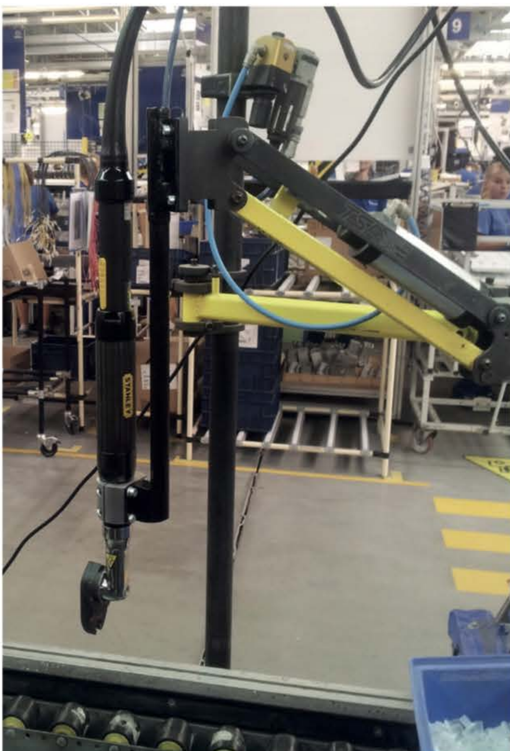
Stanowisko do montażu przewodów w kuchence gazowej oparte na narzędzi elektrycznym STANLEY i specjalnym ramieniu reakcyjnym
