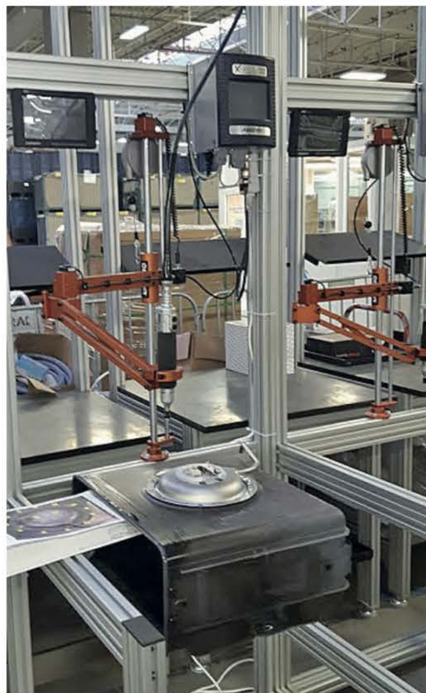
Stanowiska do montażu podzespołu kuchenki elektrycznej/piekarnika oparte na wkrętaku elektrycznym ASG i ramieniu reakcyjnym firmy DOGA z systemem wizualizacji procesu oraz sekwencyjnego dokręcania.
