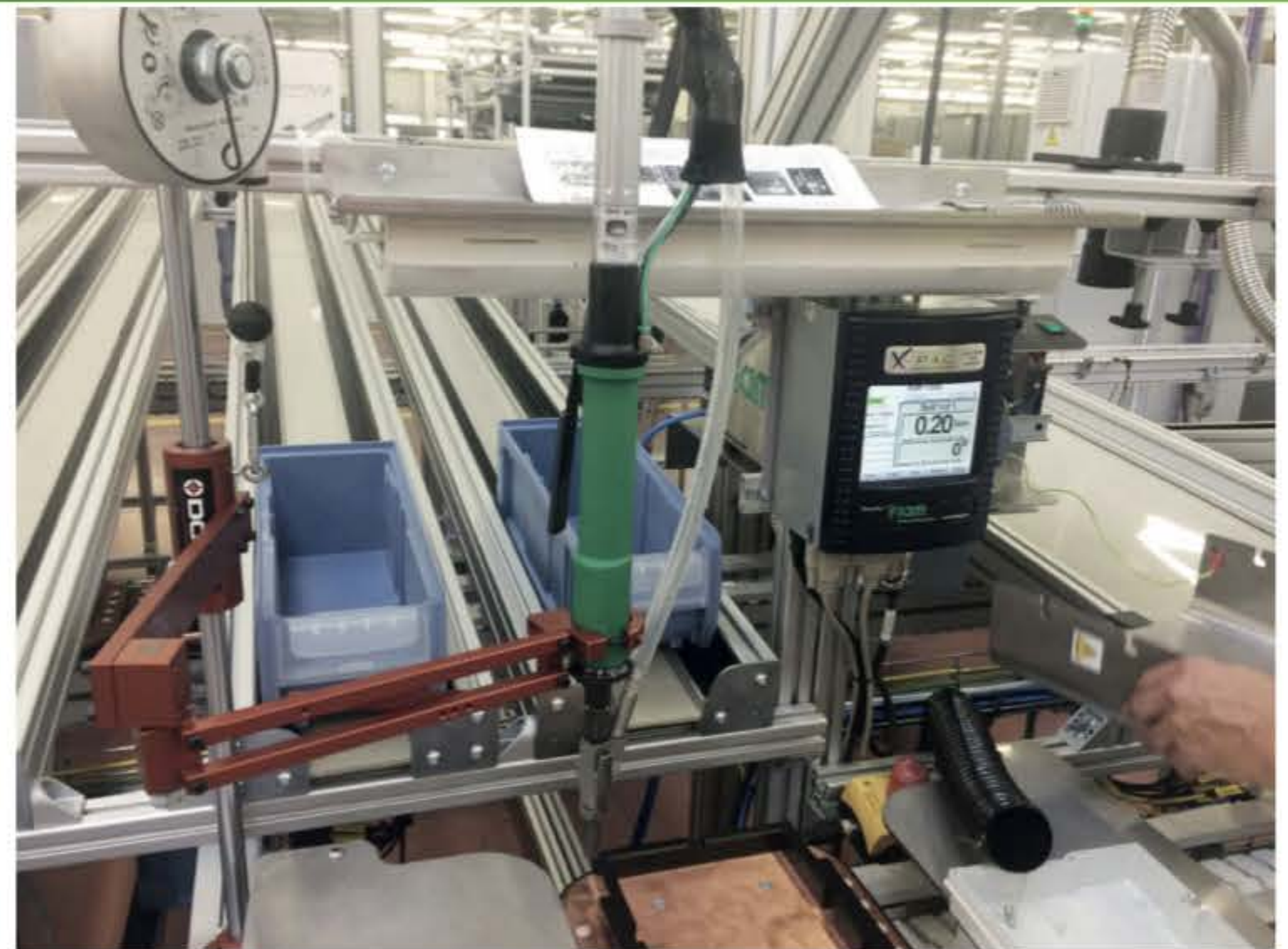
Stanowisko montażu ręcznego urządzeń pomiarowych wyposażone we wkrętarkę automatyczną FIAM z napędem elektrycznym ASG zamontowane na ramieniu reakcyjnym DOGA
