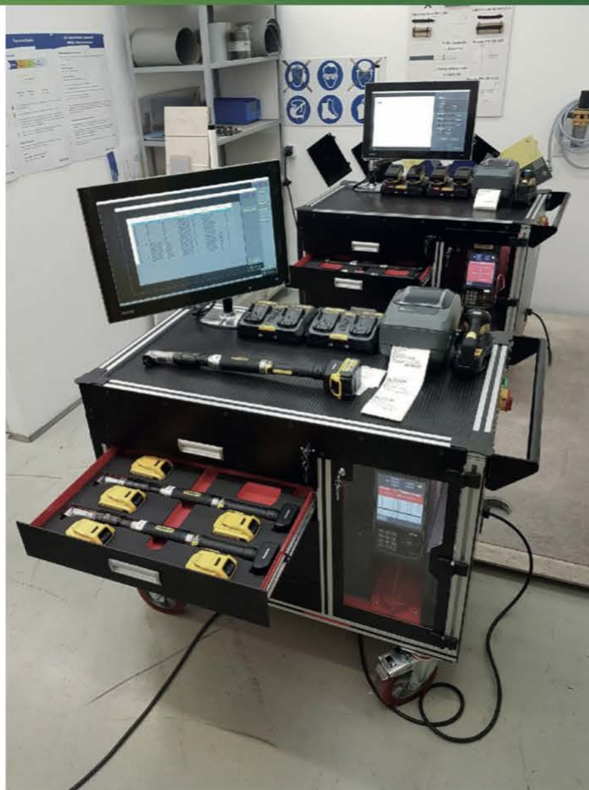
Mobilna stacja dokręcania wyposażona w narzędzia przetwornikowe firmy Stanley
