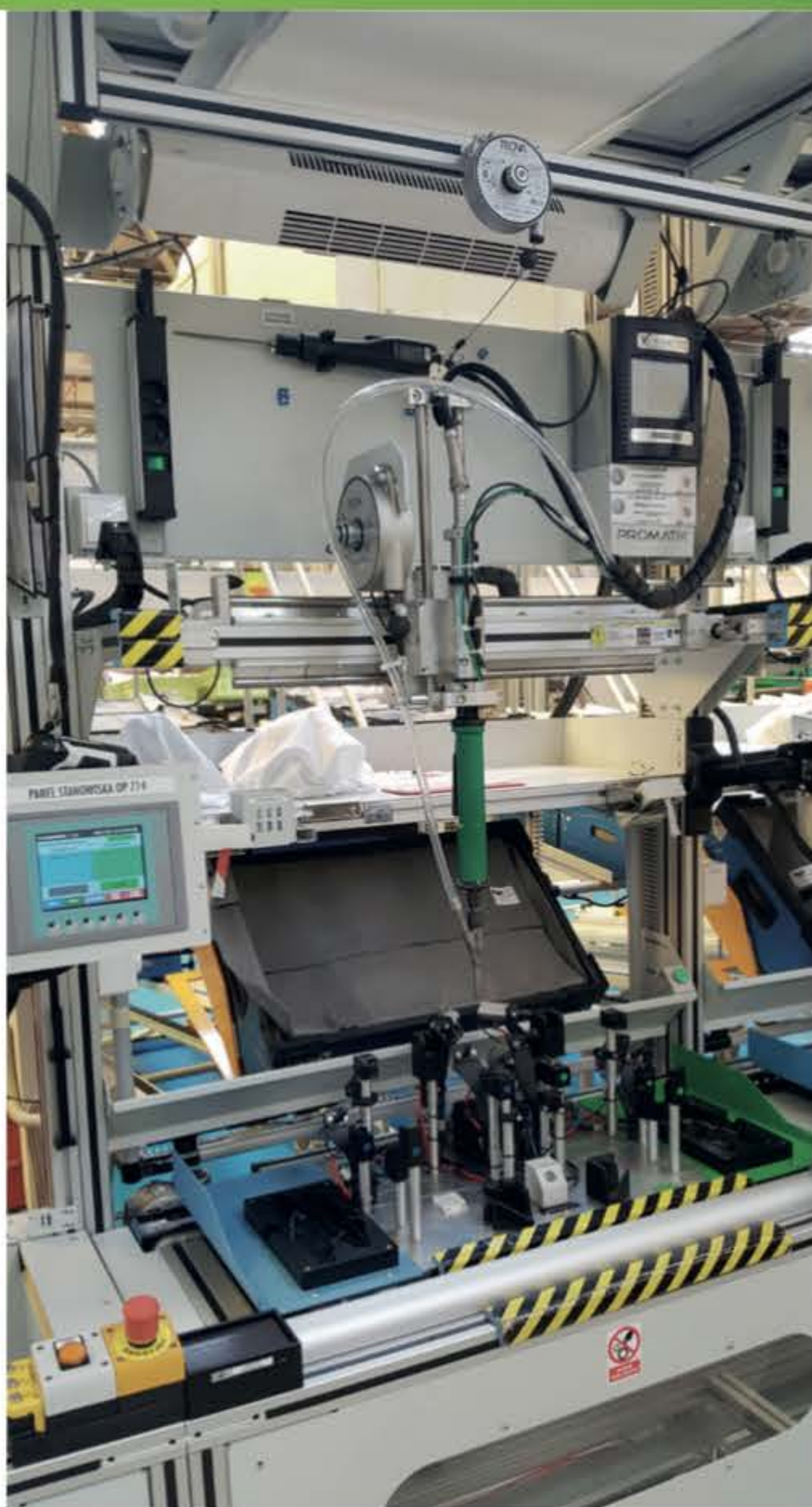
Stanowisko montażowe wyposażone we wkrętkę ASG z podajnikiem wkrętów zamontowaną na ramieniu reakcyjnym
