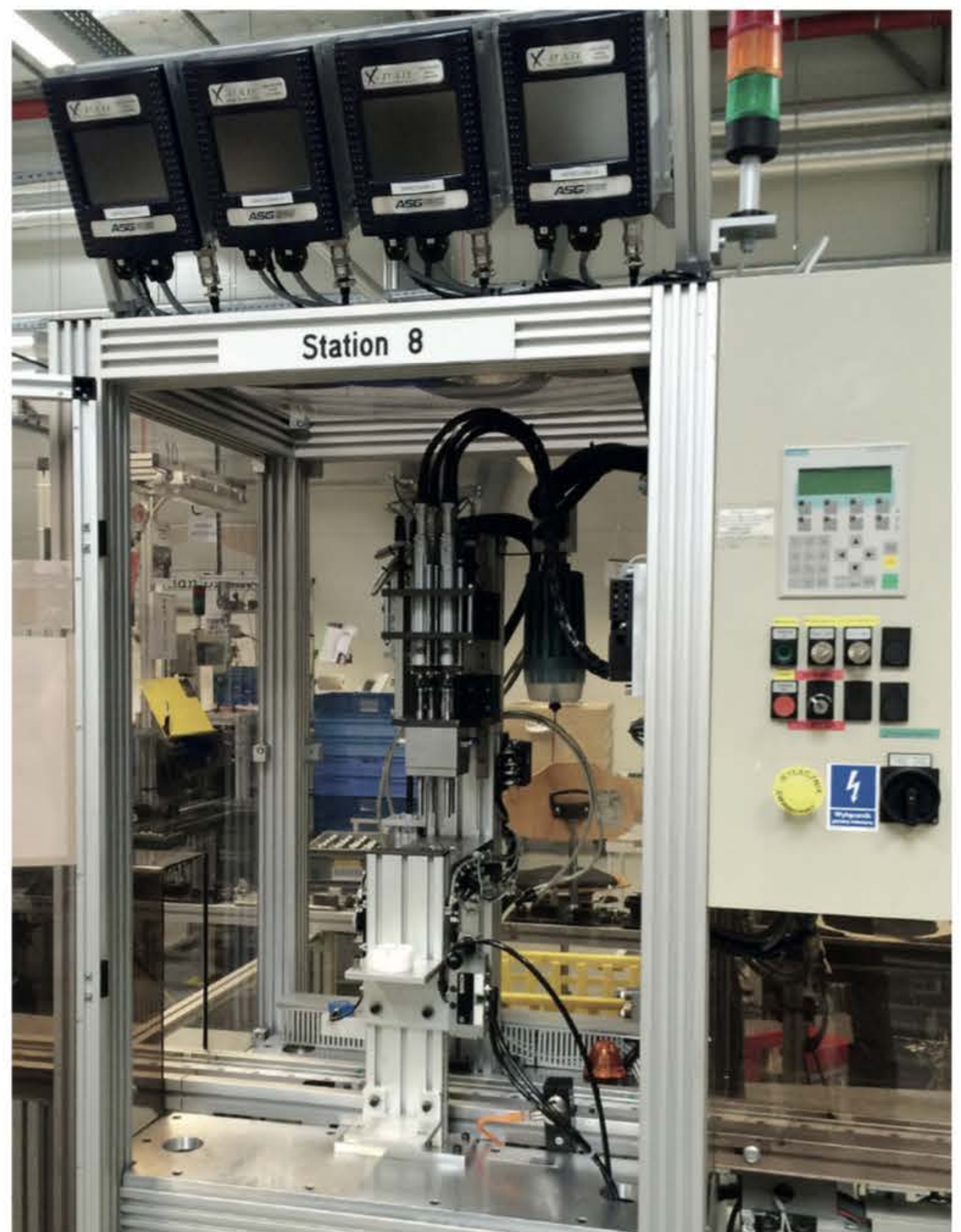
Stanowisko do jednoczesnego montażu 4 śrub oparte na wrzecionach elektrycznych firmy ASG
