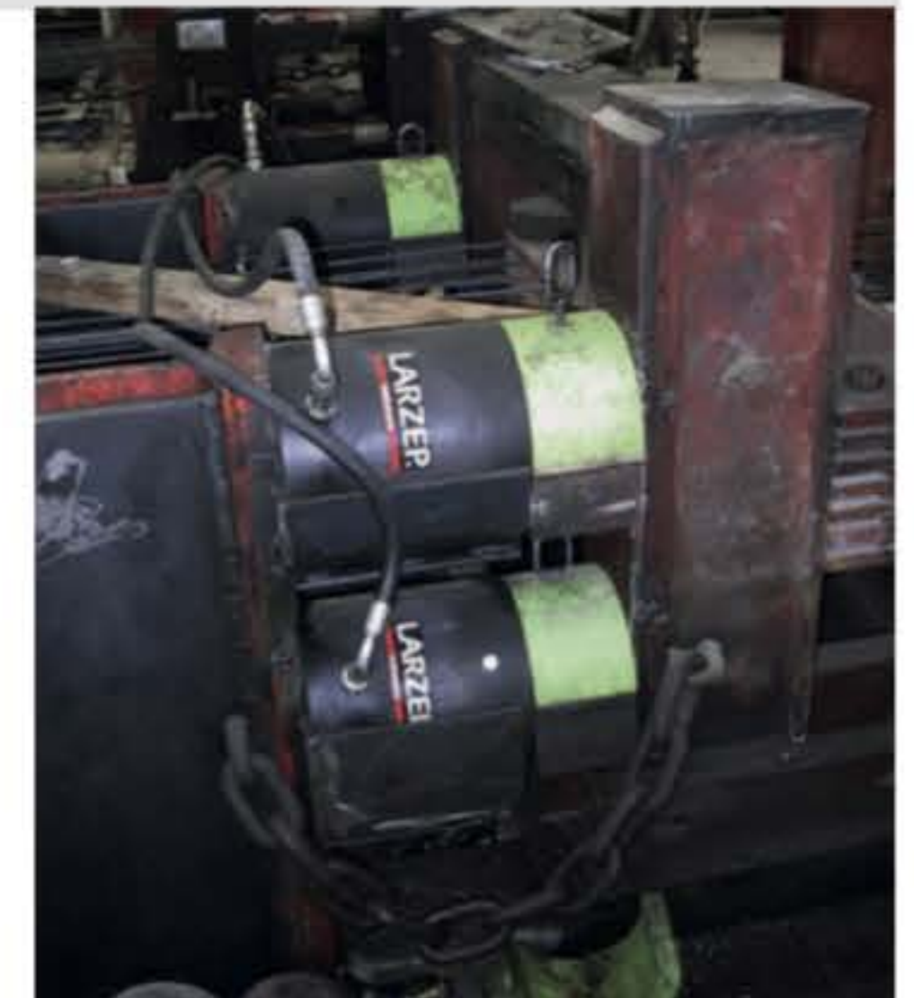
Sprężanie belek strunobetonowych
