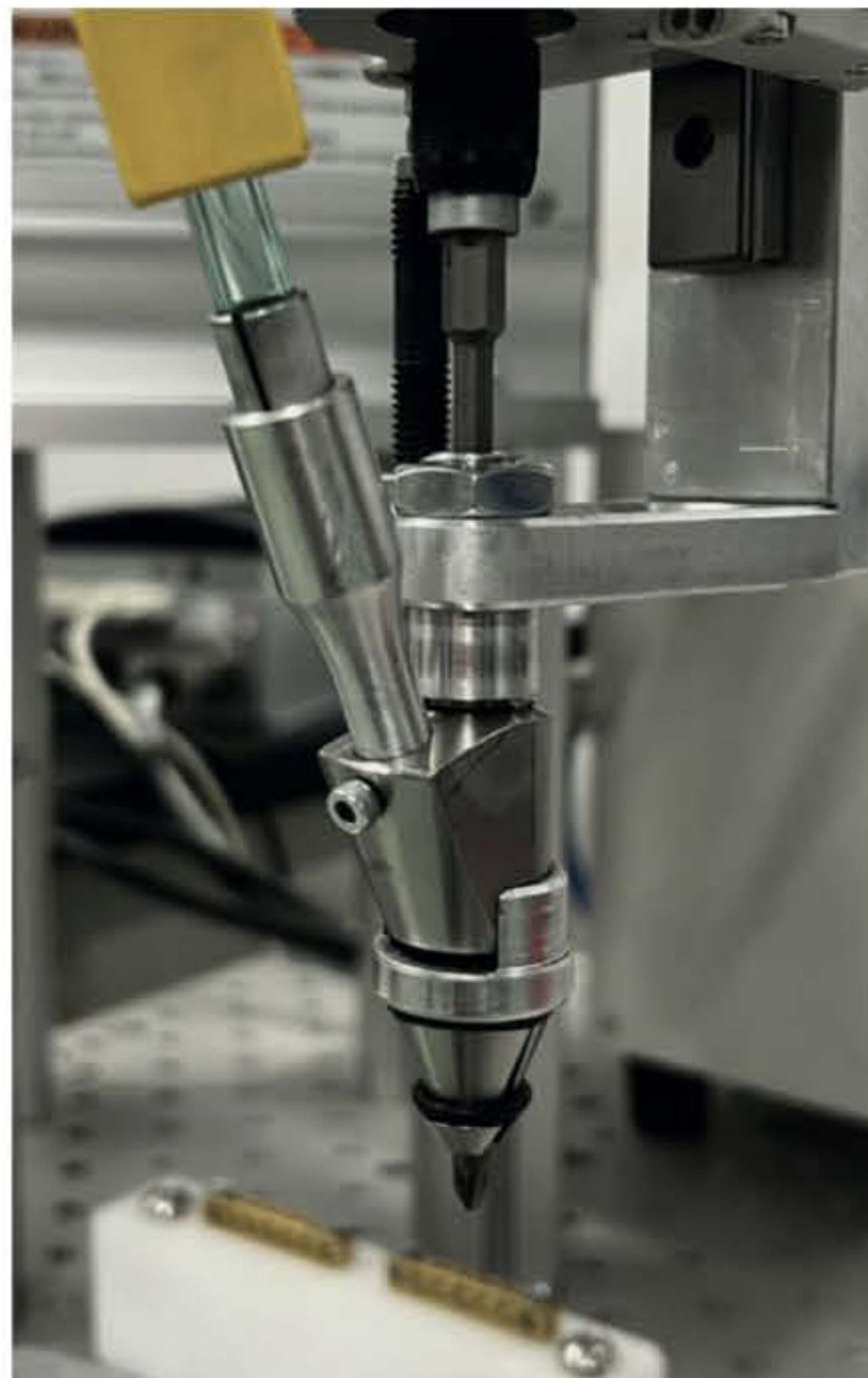
Automatyczne wkręcanie śrub przy pomocy wkrętarki ASG zamontowanej na robocie Yaskawa
